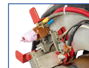
Schneller Wechsel der Elektrode durch das Kippsystem des Brenners für MU IV HW
