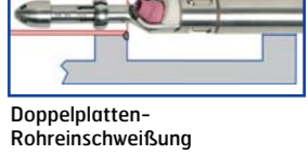
Doppelplatten-Rohrschweißung von gering überstehenden Rohren
