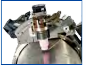
Brennereinheit mit motorisiertem Kreuzschlitten für AVC, OSC und verstellbarer Drahtzuführung
