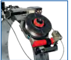
Integrierter Drahtvorschub mit Richtwerk
